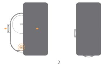
3. Чтобы улучшить характеристики зарядки, убедитесь, что телефон правильно установлен на беспроводной автомобильной зарядке, так чтобы он находился близко к поверхности зарядки (см. рисунок ниже). Когда индикатор мигает, это означает, что зарядка находится в режиме защиты. Пожалуйста, проверьте, есть ли металлический предмет на поверхности зарядки или на задней панели телефона. Если проблема не устранена, обратитесь в отдел послепродажного обслуживания.\*
