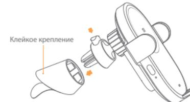
Примечание: Поверхность для установки беспроводной автомобильной зарядки должна быть чистой и ровной. Из-за прочности клея принудительное удаление может повредить салон автомобиля. Рекомендуется профессионально снять клейкое крепление.
